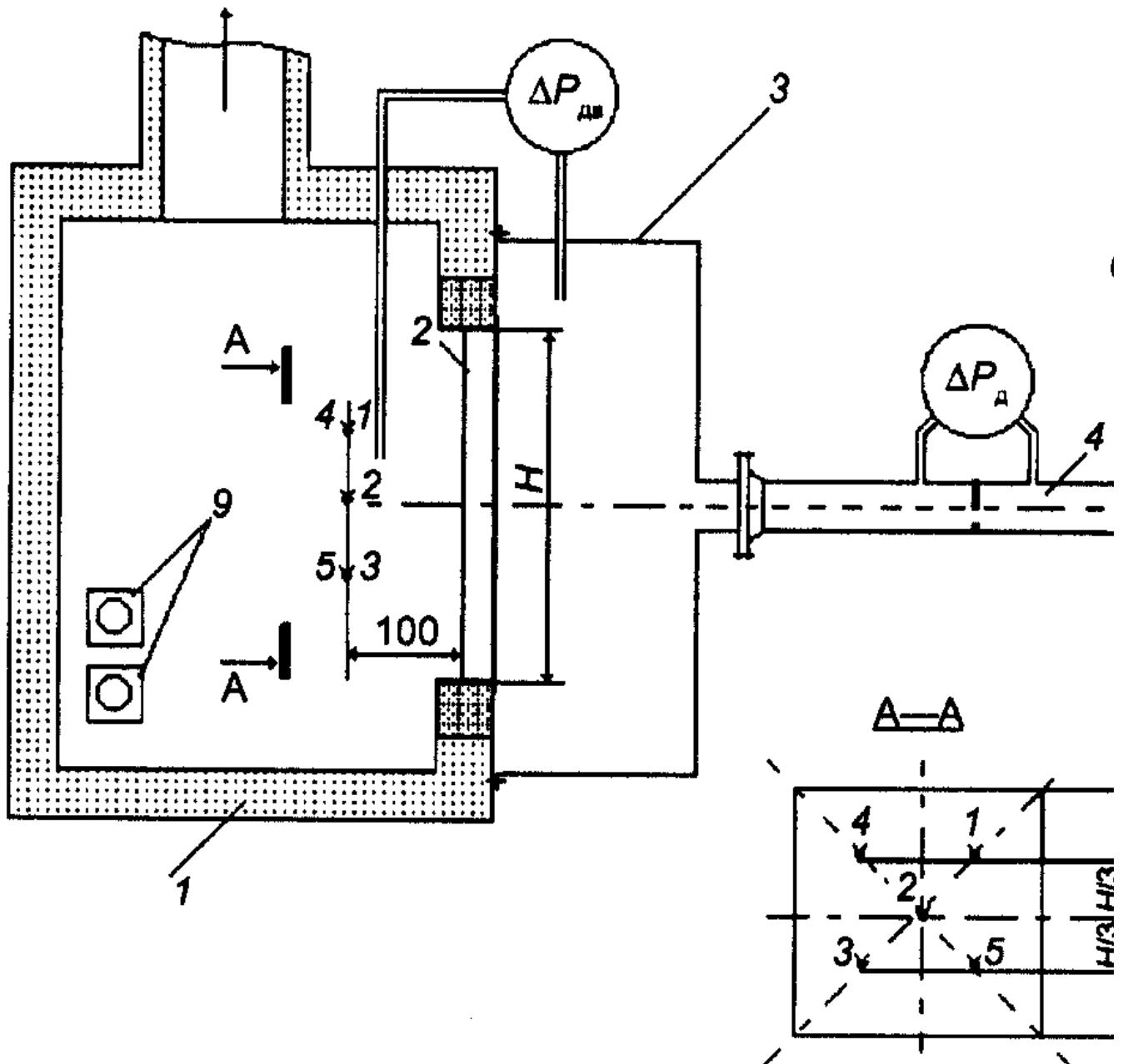
1 - печь; 2 - испытываемый образец двери; 3 - пневмокамера; 4 - стенд определения расходных характеристик инженерного оборудования; 6 - регулирующая заслонка; 7 - воздуховоды обвязки стенда; 8 - вентилятор; 9 - форсунки;
