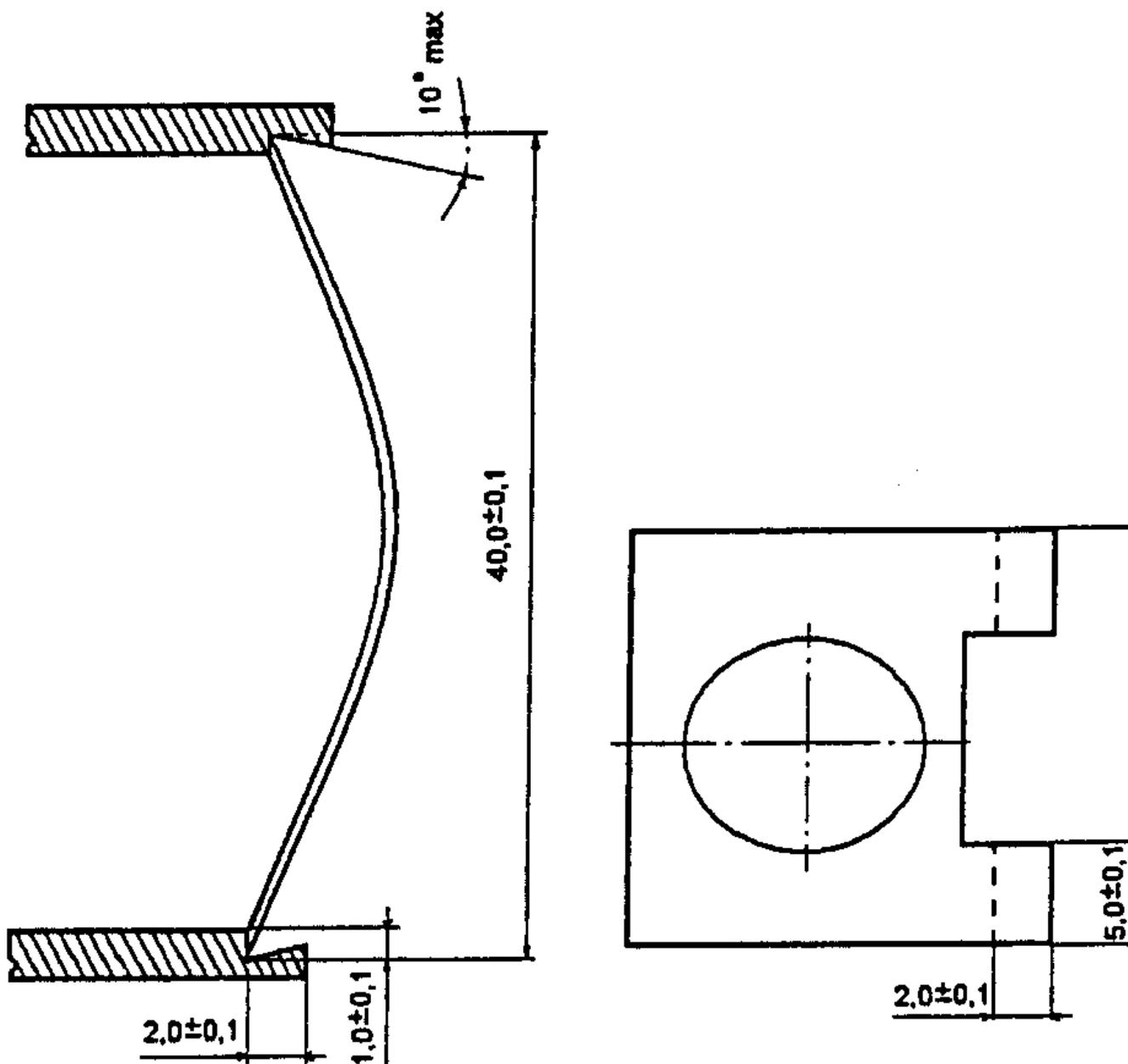
Рисунок а3. Захваты (вид сбоку с испытуемой пластиной в первоначальном положении и вид сверху без испытуемой пластины)
