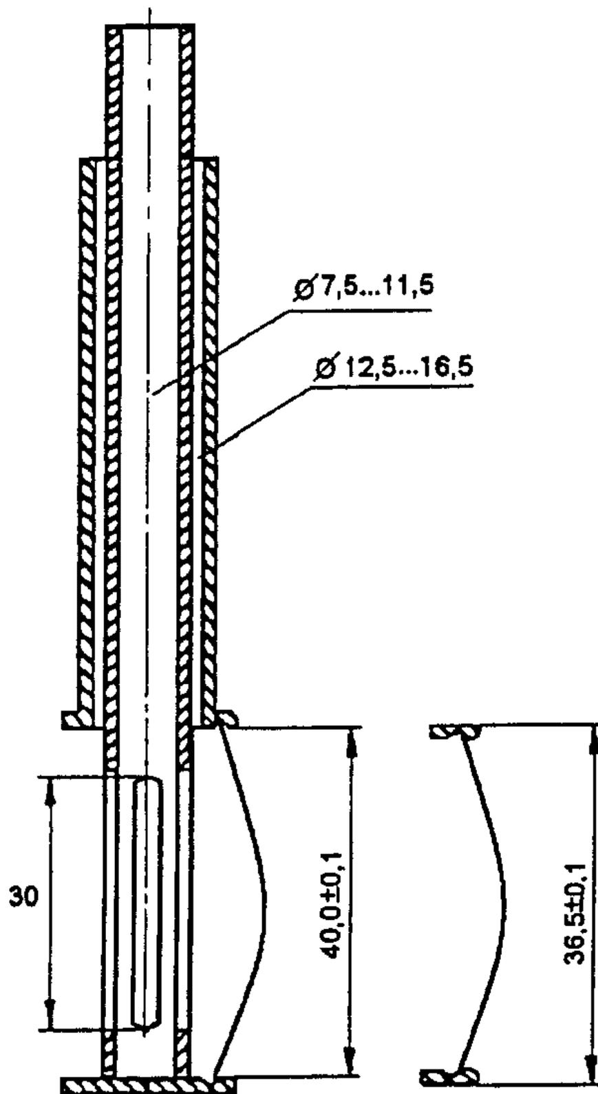
Рисунок а2. Устройство для сгибания пластинки
