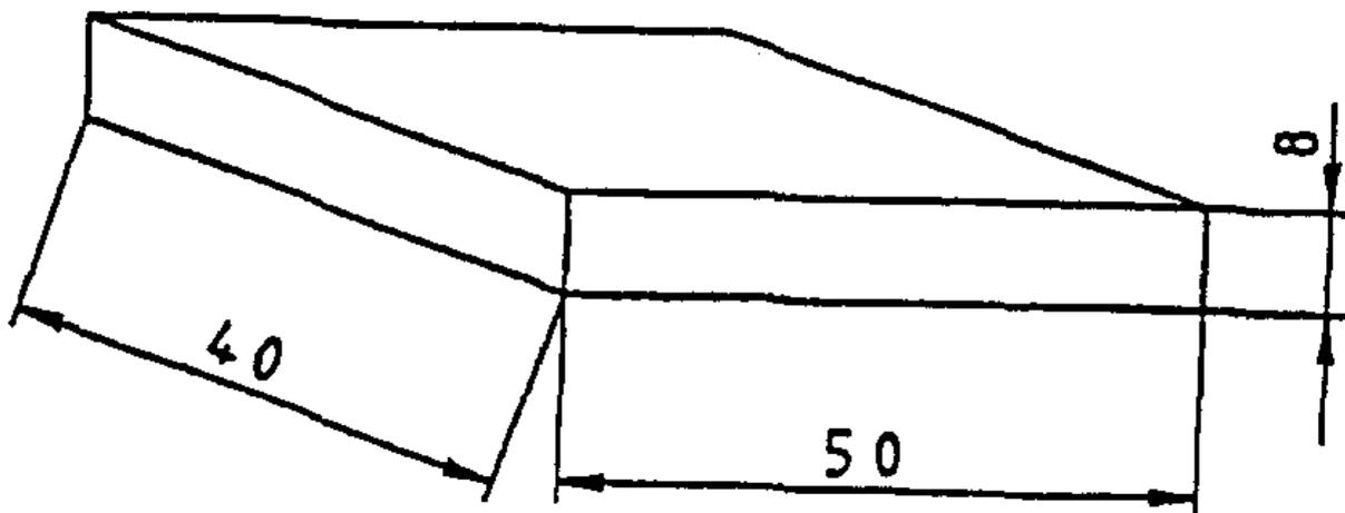
**Рисунок г2. Магнитный блок и крышка**
