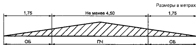
Рис. 11. Поперечные профили автомобильных дорог категории IV без ограждений
